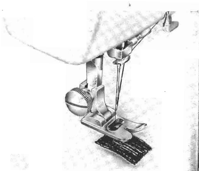
Stellen Sie die Maschine lt. obiger Tabelle ein. Beachten Sie : der Transporteur ist auf UNTEN, der Füßchendruck auf 0 gestellt! Unterlegen Sie die schadhafte Stelle, falls nötig. Legen Sie diese dann unter den Nähfuß und lassen ihn herab, da sonst die Fadenspannung nicht wirksam wird.
