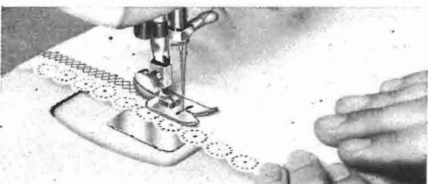
Die Spitze etwa 5mm von der Stoffkante entfernt auf den Stoff und unter den Nähfuß legen.
